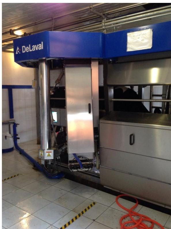
**Рис. 6 «Робот-дойяр» компании DeLaval**
